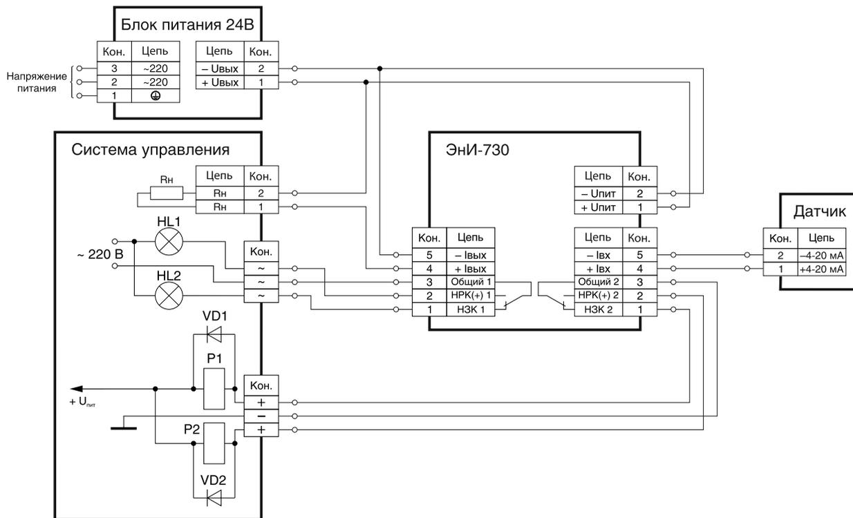
Рисунок Б.2 — Схема подключения индикатора с питанием от внешнего источника питания и дискретными выходами типа «Г» — реле, перекидной контакт
