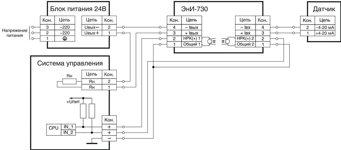
Рисунок Б.1 — Схема подключения индикатора с питанием от токовой петли и дискретными выходами типа «Б» — транзистор
