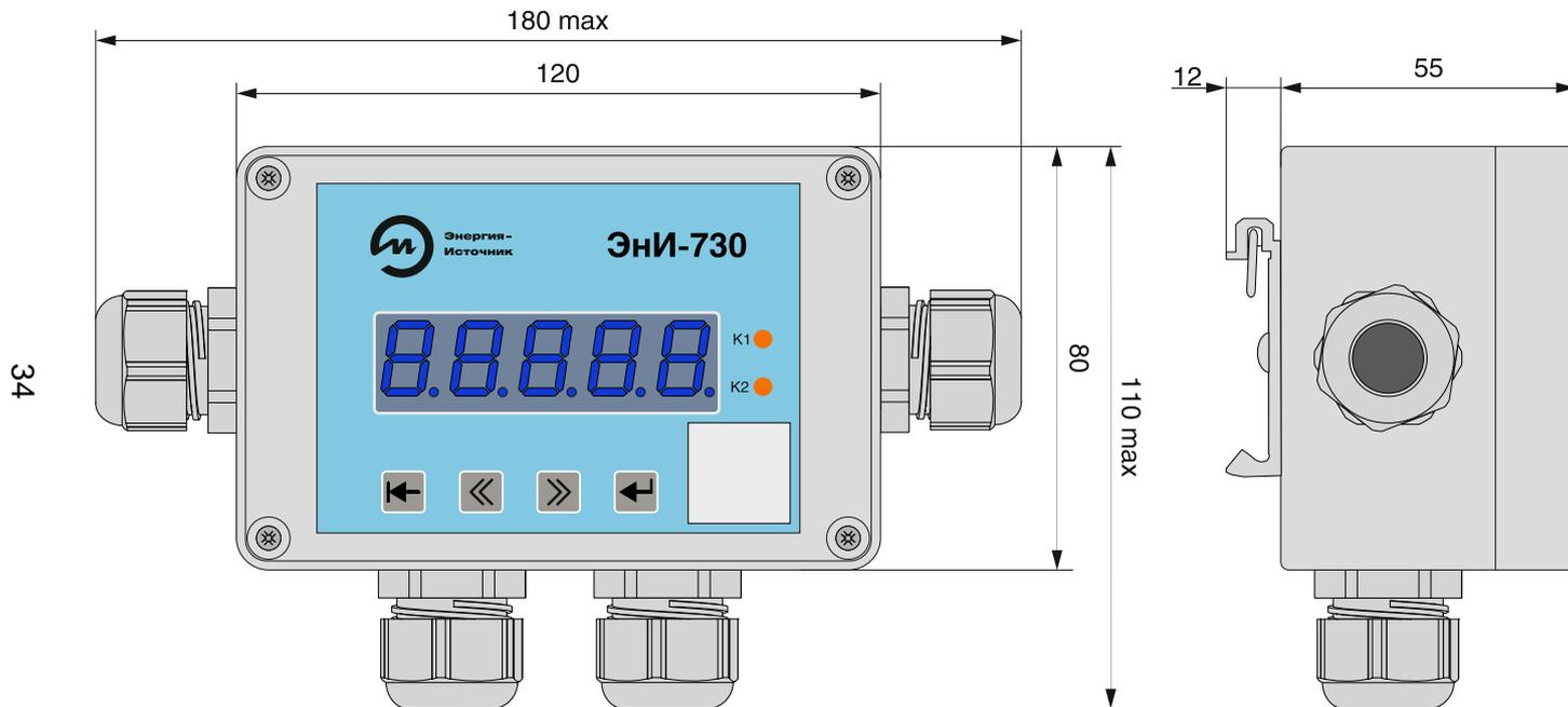
Рисунок А.1 — Габаритные размеры
