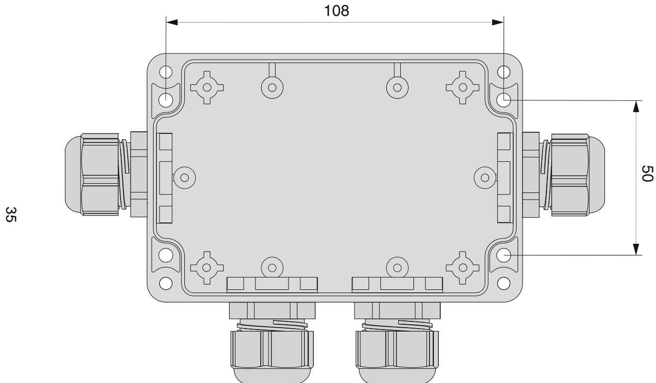
Рисунок А.2 — Монтажные размеры
