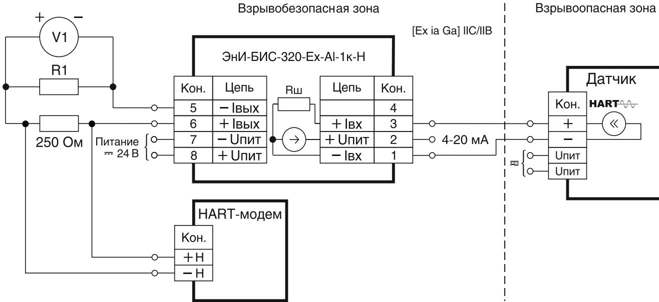
Рисунок Б.7 — Схема подключения барьера ЭНИ-БИС-320-Ex-Al-1к-Н
