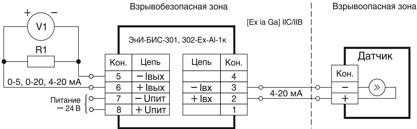
Рисунок Б.1 — Схема подключения барьеров ЭНИ-БИС-301-Ex-Al-1к, ЭНИ-БИС-302-Ex-Al-1к
