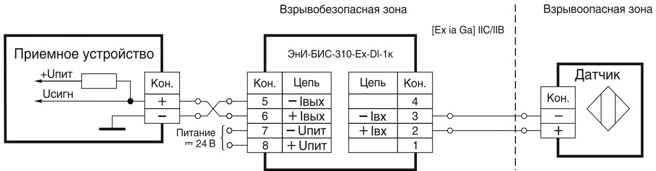
Датчик — датчик с выходным сигналом по стандарту NAMUR.
