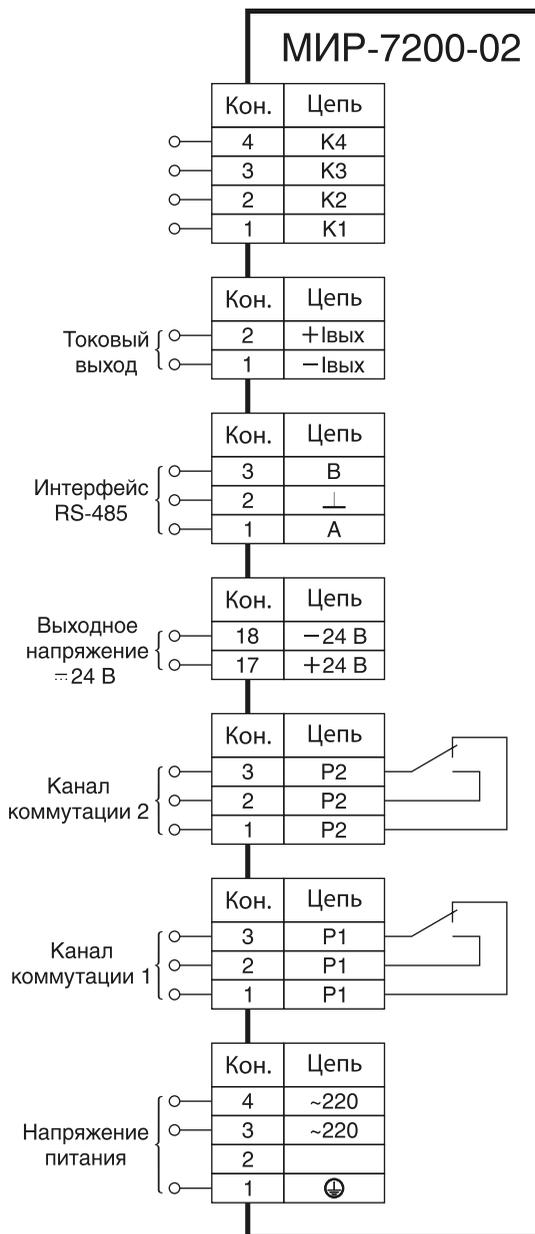
Рисунок Б.5 — Схема подключения к регулятору исполнения 02
