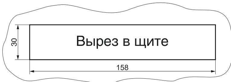
Рисунок А.10 — Разметка отверстия в щите для установки регулятора исполнения 02
