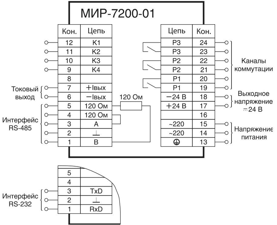
Рисунок Б.3 — Схема подключения к регулятору исполнения 01
