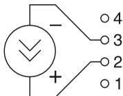
Схема подключения при измерении постоянного тока
