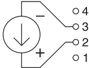
Схема подключения при измерении напряжения постоянного тока
