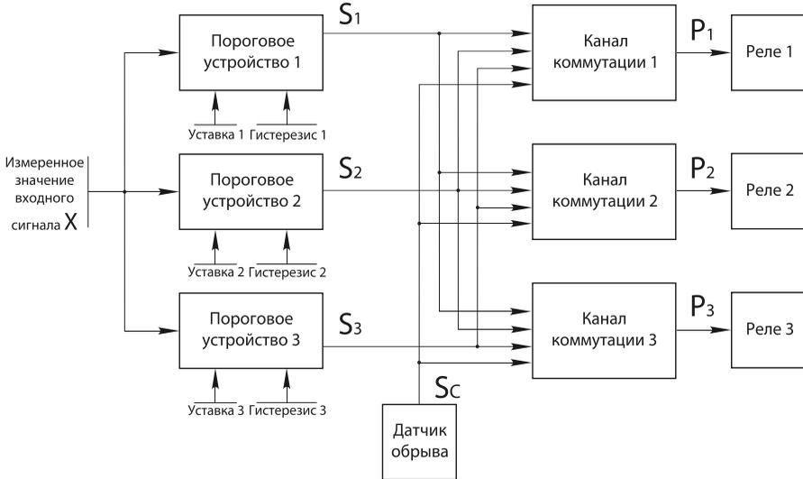
$S_1, S_2, S_3$  — выходные сигналы пороговых устройств;
