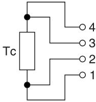
Подключения термопреобразователя сопротивления по 4-х проводной схеме
