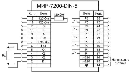
Рисунок В.7 — Схема подключения регулятора исполнения DIN с пятью каналами коммутации при определении приведенной погрешности в режимах измерения сопротивления, сигналов от термопреобразователей сопротивления
