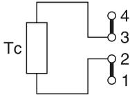
Подключения термопреобразователя сопротивления по 2-х проводной схеме
