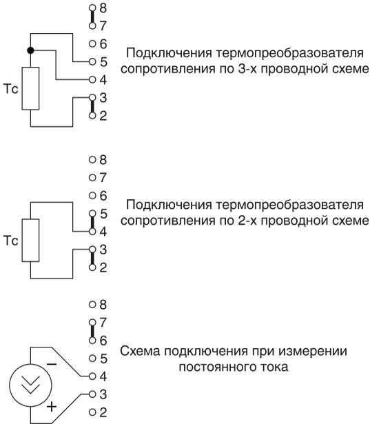
Рисунок Б.9 — Схемы подключений термпреобразователей сопротивления по 2-х и 3-х проводным схемам, подключение при измерении силы постоянного тока к регулятору исполнения DIN с пятью каналами коммутации
