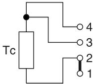
Подключения термопреобразователя сопротивления по 3-х проводной схеме
