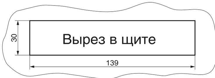
Рисунок А.11 — Разметка отверстия в щите для установки регулятора исполнения 03
