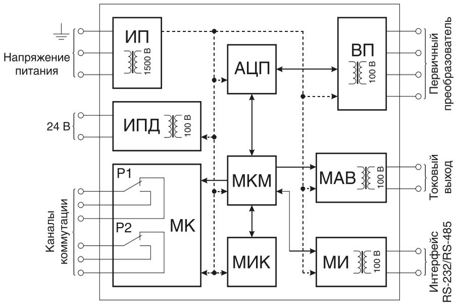
Рисунок 2 — Функциональная схема регулятора в исполнении 02 и 03
