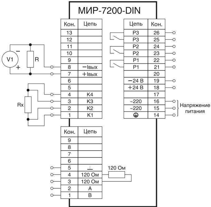
Рисунок В.5 — Схема подключения регулятора исполнения DIN при определении приведенной погрешности в режимах измерения сопротивления, сигналов от термопреобразователей сопротивления
