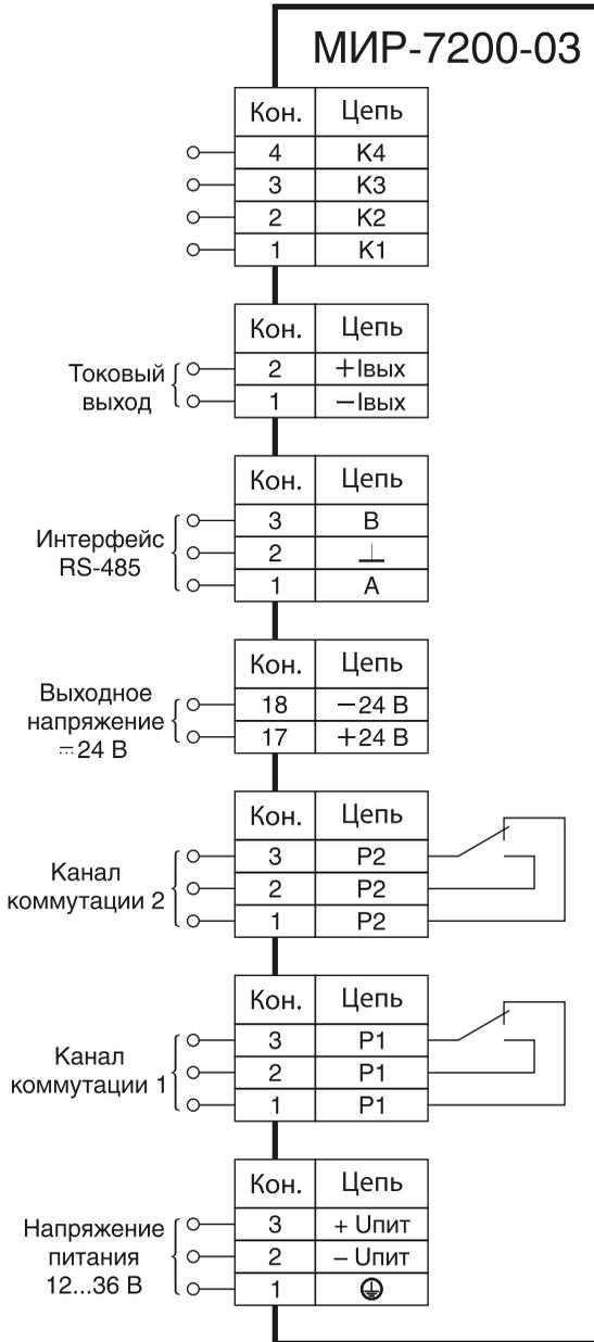
Рисунок Б.6 — Схема подключения к регулятору исполнения 03
