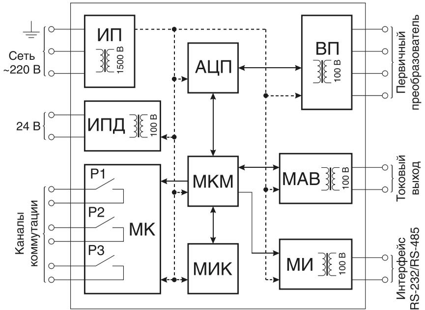
Рисунок 1 — Функциональная схема регуляторов в исполнении DIN и 01
