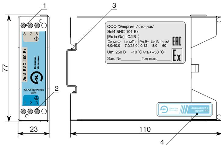
Рисунок А.1 — Габаритные размеры барьеров ЭНИ-БИС-101, 102, 111-Ex
